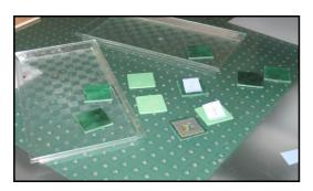
Figure 1: la table Tangisense et les tags RFID utilisés pour la catégorisation des textures sonores
